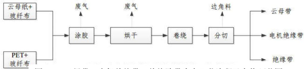
图 1-2 云母带、电机绝缘带、绝缘胶带生产工艺流程及产物环节图
