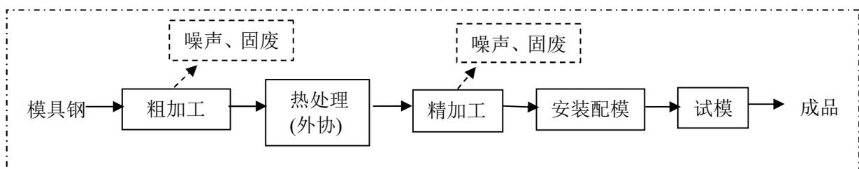
图 5-2 模具制作工艺流程和产污环节图
