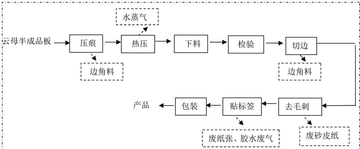
图 5-1 产品生产工艺流程和产污环节图
