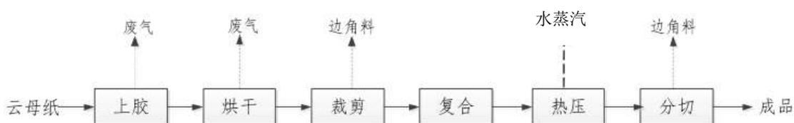
图 1-1 云母板生产工艺流程及产物环节图
