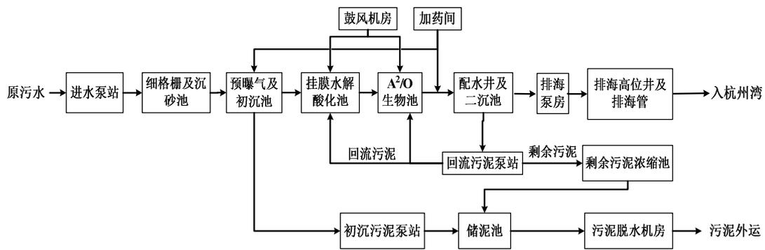
图 2-5 污水厂二期工程工艺流程框图
