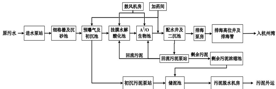
图 2-5 污水厂二期工程工艺流程框图
