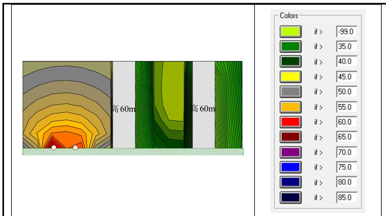
图 6-12 横三路（亚太路-纵三路）工程北侧规划居住用地第一排、第二排建筑（典型断面 K0+180）立面夜间噪声远期贡献等声级线图
