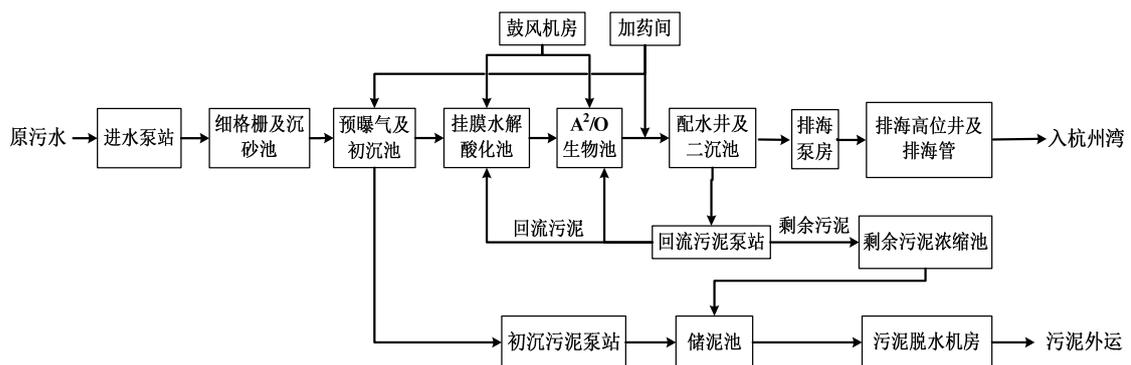
图 2-3 污水厂二期工程工艺流程框图
