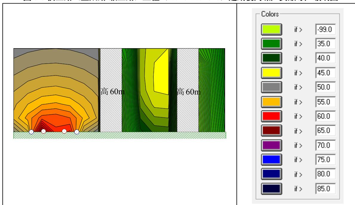
图 6-7 横三路（亚太路-纵三路）工程北侧规划居住用地第一排、第二排建筑（典型断面 K0+180）立面昼间噪声近期贡献等声级线图
