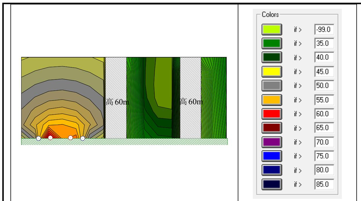
图 6-8 横三路（亚太路-纵三路）工程北侧规划居住用地第一排、第二排建筑（典型断面 K0+180）立面夜间噪声近期贡献等声级线图
