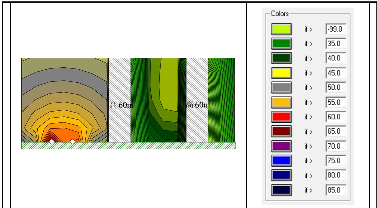
图 6-10 横三路（亚太路-纵三路）工程北侧规划居住用地第一排、第二排建筑（典型断面 K0+180）立面夜间噪声中期贡献等声级线图
