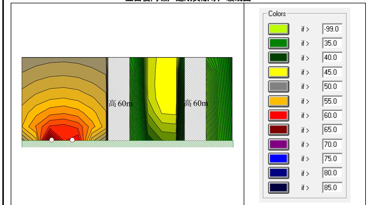
图 6-9 横三路（亚太路-纵三路）工程北侧规划居住用地第一排、第二排建筑（典型断面 K0+180）立面昼间噪声中期贡献等声级线图
