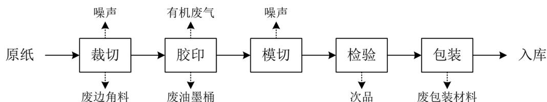
图 5-1 本项目印刷品的生产工艺流程及产污图
